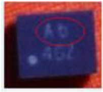
图5-10 (型号: SYR827. 对应VDD_CPU电源)
