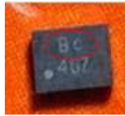
图5-11 (型号: SYR828. 对应VDD_GPU电源)
